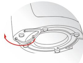
3. Нажмите кнопку подъёма крышки и, удерживая её в верхнем положении, поднимите крышку. После небольшого подъёма крышки отпустите кнопку и продолжайте поднимать до щелчка.
